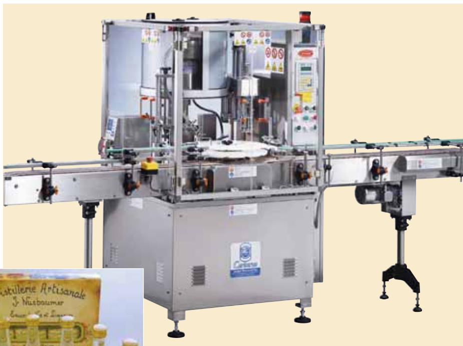
Peristaltic filler: Adelphi Cerberus handles liqueurs for Jos Nusbaumer
